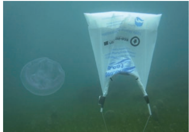
Tests de dégradation en environnement marin EcoOcean. Crédit EcoCortec
